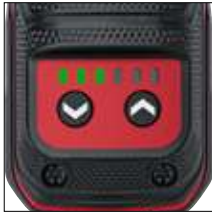
Botões para ajuste de velocidade (apenas para modelos com regulação variável de velocidade)
